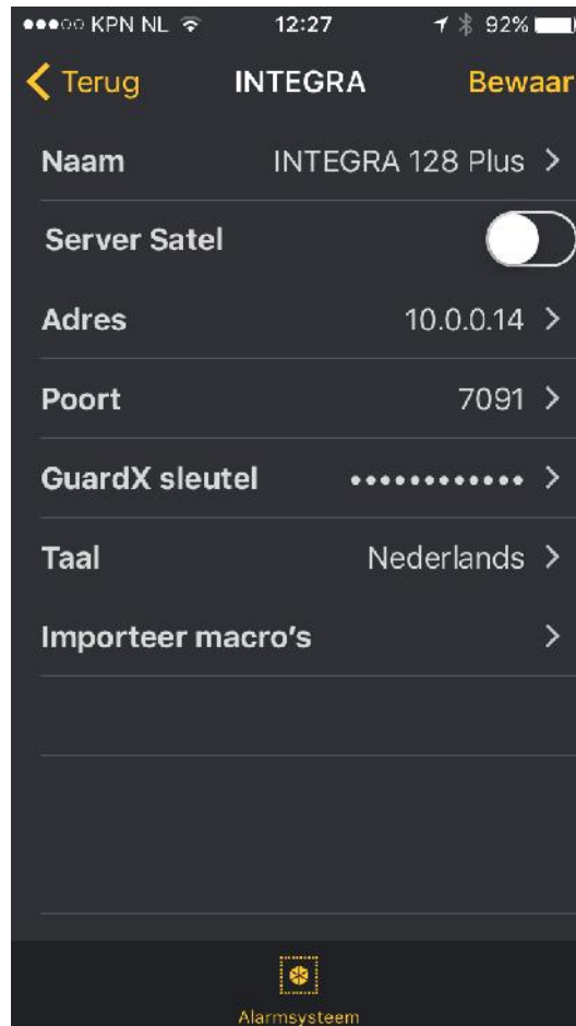
Fig. 5. INTEGRA CONTROL applicatie (iOS systeem): “Nieuw alarmsysteem” scherm met een voorbeeld van de instellingen voor directe communicatie met de module.
